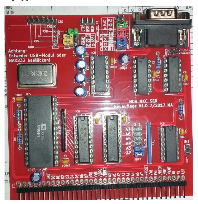
Achtung, die Jumperstellungen für Rx/Tx und RTS/CTS sind in Platinenvarianten unterschiedlich! Hier ist die Verbinung 1:1 für beide Signalpaare eingestellt. Die IO-Adresse ist für OFOh..0F2h gejumpert.
